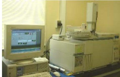
分析計を介して標準物質と汚染物質とを比較することにより、空气中や水中の汚染物質の濃度を知ることができる。
